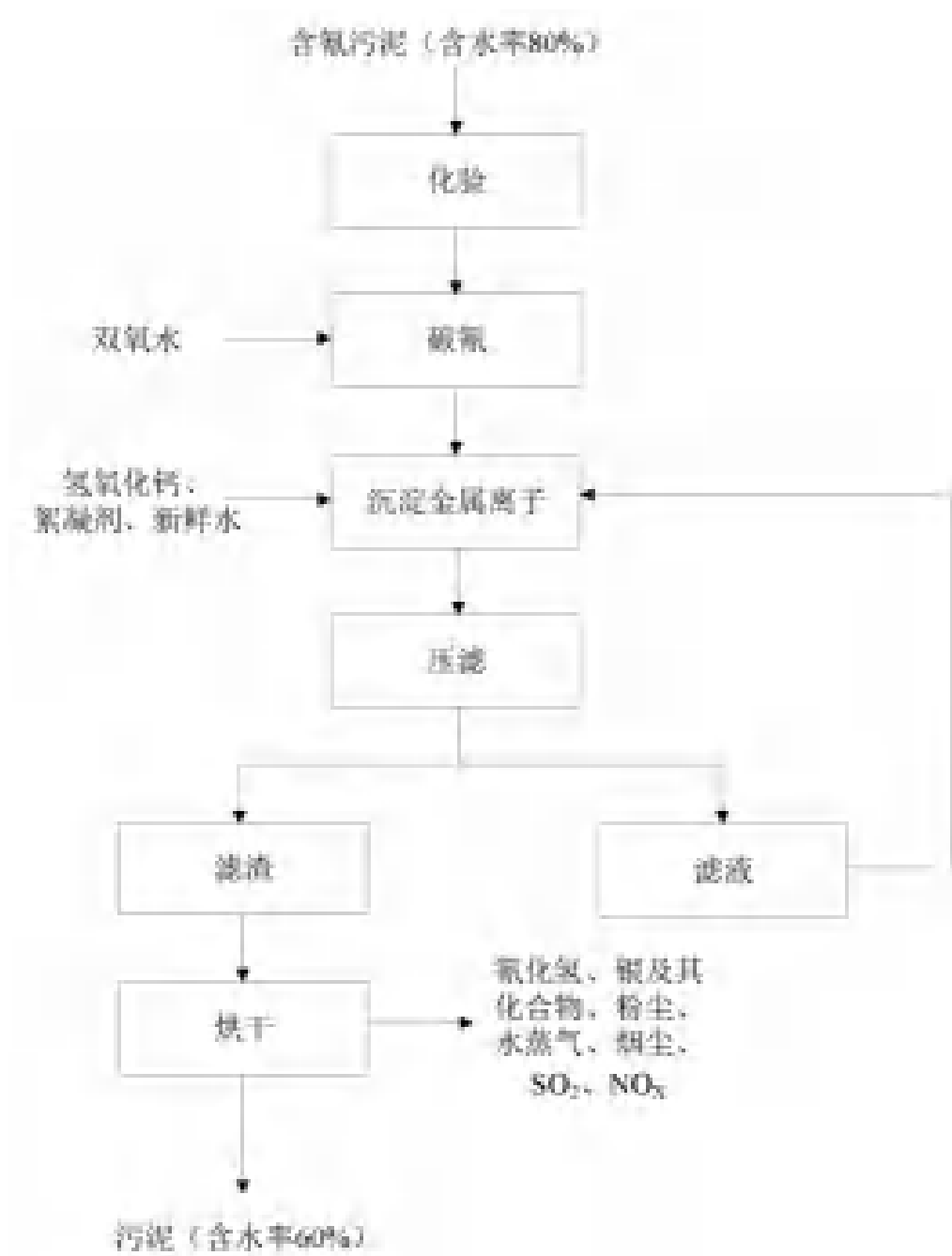
图 3.6-2 含微量氰化物的贵金属污泥（HW33）预处理工艺流程图
