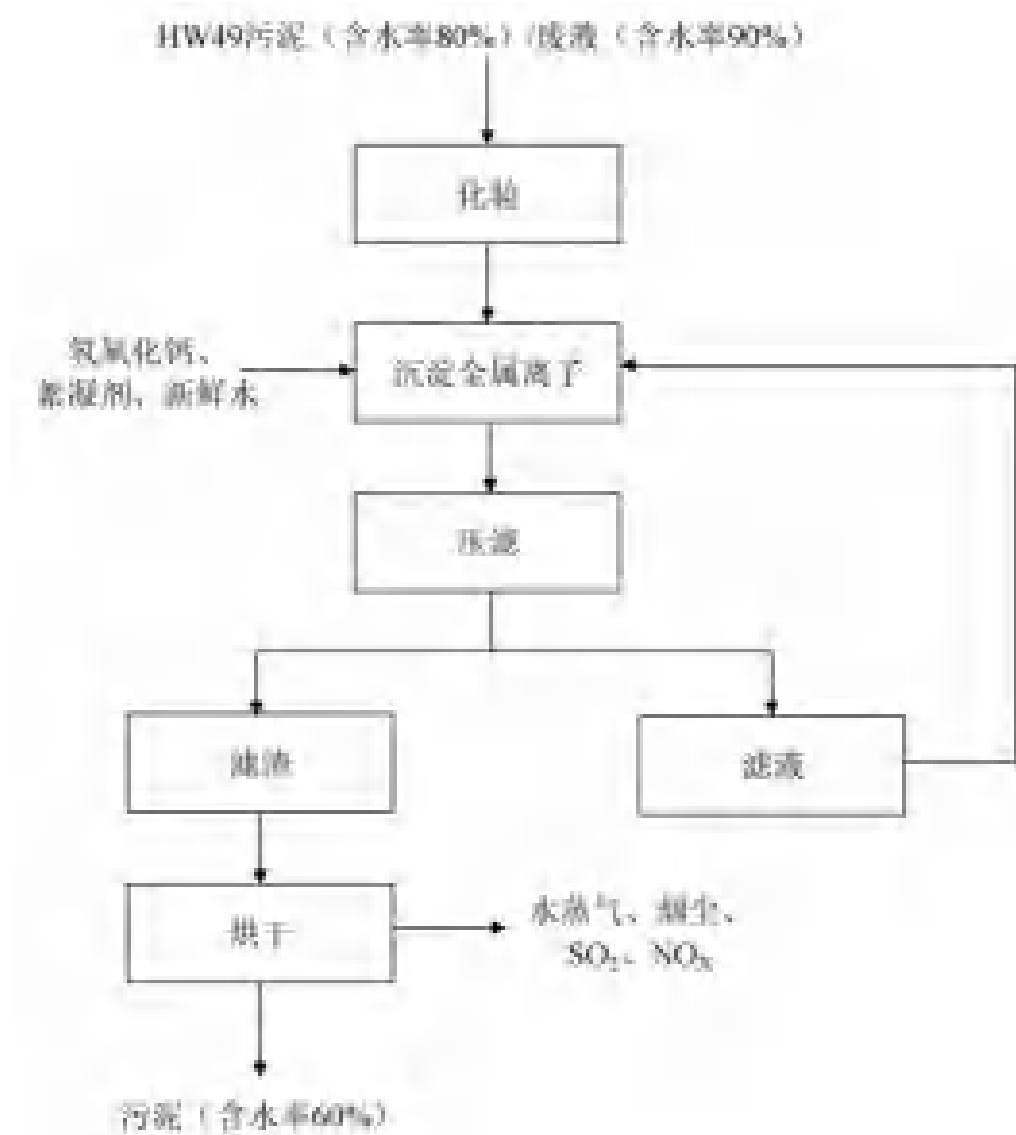
图 3.6-3 离子交换装置再生过程产生的废液和污泥（HW49）预处理流程图
