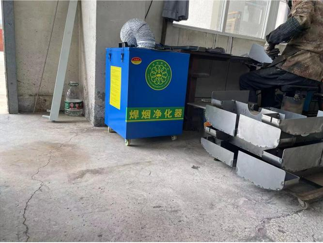
图4-4移动式烟尘净化器
