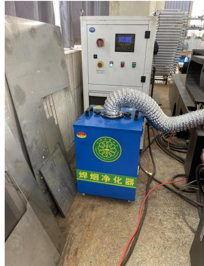
图4-3移动式烟尘净化器
