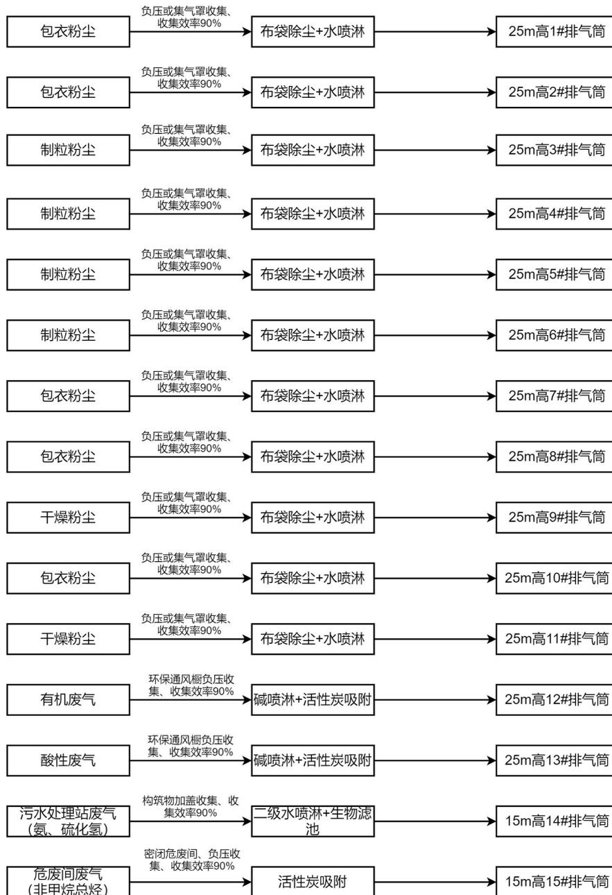
图4-2项目废气收集、处理示意图
